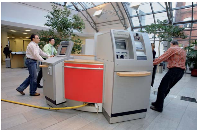
Die SB-Insel „in Aktion“: Auf acht Luftkissen wird das 3,5 Tonnen schwere System mit leichter Hand von einem Ort zum anderen bewegt.
