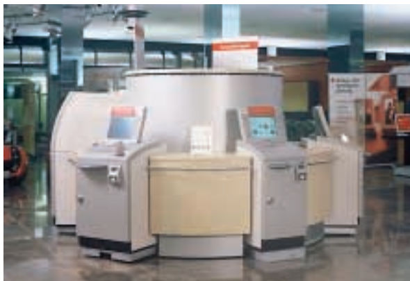
Links oben/unten: SB-Insel im Tagesbetrieb und mit elektromotorisch ausgefahrenem Technikraum.
